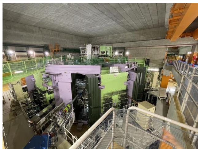
写真 2. 超電導リングサイクロトロン
